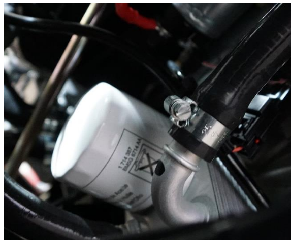
Filter d'origine à l'achat du véhicule : Ford – 1 714 387 - BM5G 6714 AA
